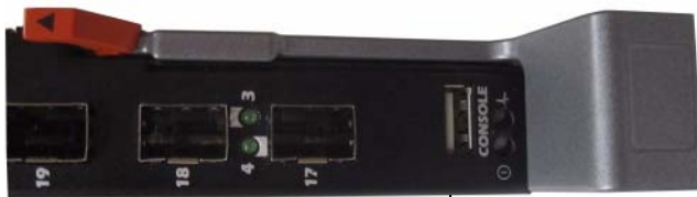
図 1-4. PowerConnect M8024-k USB コンソールポート
