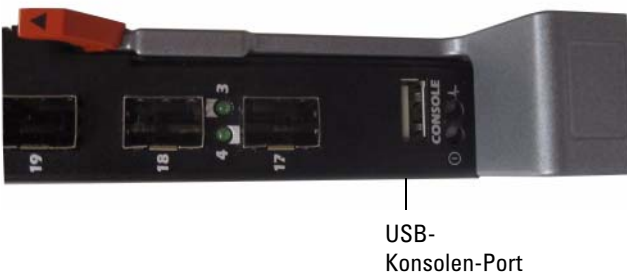
Abbildung 1-4. PowerConnect M8024-k USB-Konsolen-Port
