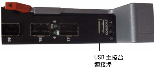
圖 1-4. PowerConnect M8024-k USB 主控台連接埠
